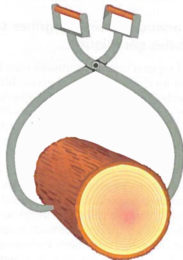
Figure 19-47 Les pinces à bois. Quand on tient les deux poignées ensemble, les griffes agrippent la bûche ; et quand les griffes sont appliquées sur la bûche, les poignées se rassemblent. De plus, plus on tire sur les pinces, plus l'emprise est forte des deux côtés. Avec une molécule d'intégrine, les détails de la liaison sont différents, mais le principe mécanique est le même : des modifications conformationnelles aux deux extrémités opposées de la molécule sont couplées et le fait de tirer resserre l'emprise.
